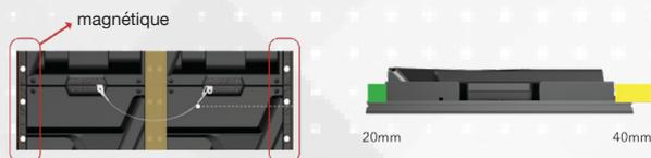
La conception des modules des dalles INTEGRAL a été étudiée pour offrir une grande facilité de maintenance avec un temps réduit. L'ensemble des modules intègrent un système magnétique permettant un accès à l'électronique aussi bien par l'avant que par l'arrière.
